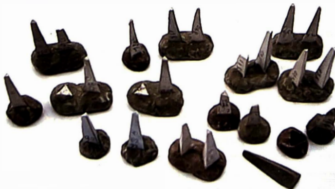
Afb. 55: Gebruikte Segherskegeltjes uit de pottenbakkerij Ver Elst-Dupont.
