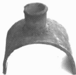
Schouwveurst in Poperings rood aardewerk. De pot is handgedraaid. Afmetingen 40,5 op 25,5 cm, hoogte 37 cm, hoogte pot 12 cm. Herkomst: Maurice Devos, Chalet de l'amitié, Krombeekseweg Westvleteren. (MA)
