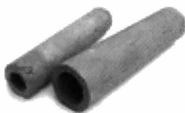
Gebakken draineerbuisen uit de pottenbakkerij Ver Elst-Dupont: buis van 3 cm binnendiameter en 30 cm lengte alsook 5 cm en 33 cm lengte.
