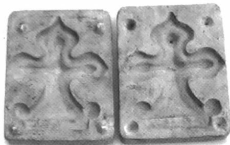
Gipsen vorm voor nokversiering van schalieveursten. Afmetingen van de gesloten vorm: 17,7 x 23 x 8 cm.
