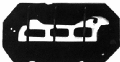
Ijzeren persvorm voor muurpan met 3 openingen
