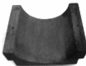
Houten goot voor één buis, lengte 29,8 cm, breedte 37,2 cm, gootbreedte 27,3 cm. Sporen van rood chamottepoeder, op de zijrand zijn drie inkervingen.
