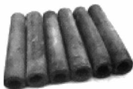
Reeks draineerbuisen van 30 cm lengte en 3 cm binnendiameter. Dit type met kleine diameter werd uit productie genomen omdat deze draineerbuisen verstopten door de kleine doorsnede.
