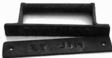
Metalen merkstempels voor gegolfde dakpannen
