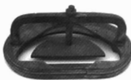
Binnenkant van de persvorm met de brug.
