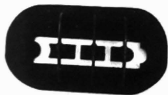
IJzeren persvorm voor de hoppeasttegels Dupont.
