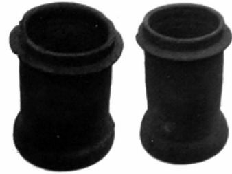
Twee handgedraaide rioolbuizen van rood ongeglazuurd aardewerk:
