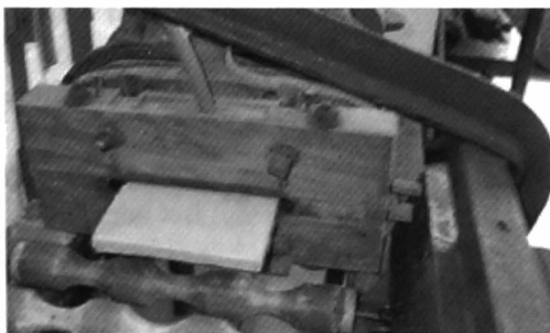
Detail van de persvorm voor haardtegels
