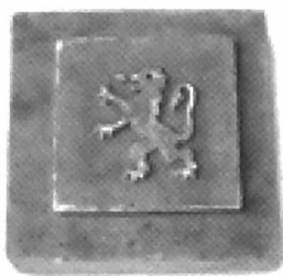
Gipsen vorm, afmetingen: 22,4 x 22,4 x 6,8 cm, afmetingen tegeldeel: 15,3 x 15,3 cm.
