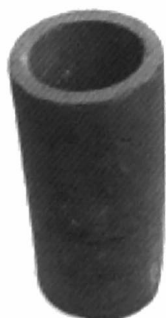
Staakbuis met binnendiameter van 10 cm en lengte van 30 cm
