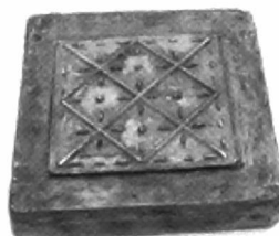
Gipsen afgietsel van de 19e-eeuwse blok. Van dit afgietsel konden gipsen tegelvormen gegoten worden. Afmetingen: 24,4 x 24,5 x 6,6 cm, afmetingen tegeldeel: 16,6 x 16,6 cm.
