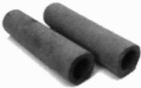
Twee draneerbuisen met vlakke bodem uit het landbouwbedrijf Wilfried Touquet te Heuvelland. Lengte 29,3 cm, binnendiameter 5 cm, dikte 1,3 cm, breedte platte kant 4,5 cm. Productiecentrum onbekend. (MA)
