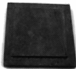
Houten vorm voor de onversierde tegel. Afmetingen: 19,5 x 19,7 x 3,1 cm, afmetingen tegeldeel: 15,1 x 15,4 cm.
