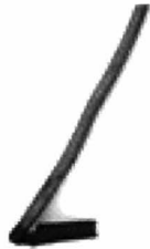
Buizentrekker, lengte van de schop 19 cm, breedte 9 à 9,5 cm.
