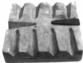
Gipsen vorm en houten model voor het vervaardigen van Segerkegels. Herkomst: pottenbakkerij Dupont.
