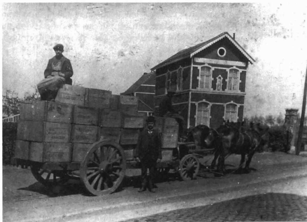
Afb.2: Typisch tweespan voor het gewone zwaar vervoer van kisten en balen: twee-assige platte wagen (baanwagen, camion) met wendbare voorwielen, zwingen en dissel tussen de paarden in. Hier met een lading palmzaad afkomstig uit de haven van Antwerpen klaar om binnen te rijden op het terrein van bloemist Auguste De Clercq in de Waterstraat in Sint-Amansberg (De Caluwé, R., Sint - Amansberg in oude prentkaarten, nr. 61).
