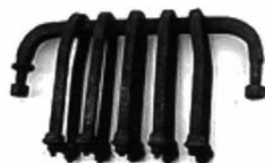
Ijzeren persbeugel voor 10 vierkante perforaties van de gevelsteen
