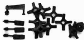
De ijzeren kleimessen van de kneedmachine in de pottenbakkerij Dupont te Poperinge.
