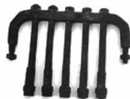
IJzeren beugel van de persvorm
