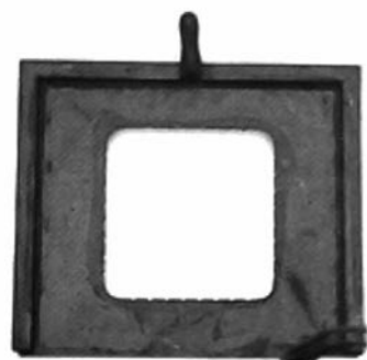
Houten model voor de persmond om schouwkokers te vervaardigen, binnenmaat van het model 27,5 x 27,5 cm.
