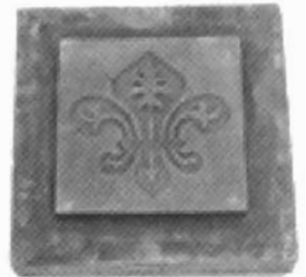
Gipsen vorm voor lelietegel in reliëf, sporen van "rood poeder" (chamotte), afmetingen: 24,5 x 24,5 x 7 cm, afmetingen tegeldeel: 16,3 x 16,3 cm.
