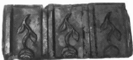
Platte dakpannen met roosversiering, rood aardewerk met donkerbruin glazuur. Merk: E Dupont-Stroom Poperinghe (1859-1893). Afmetingen 22 x 28 cm. (MA)
