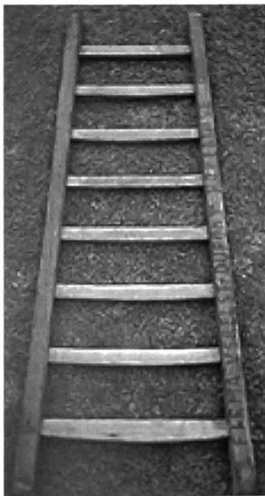
Stevige houten ladder met de tekst FIRMA VERELST-DUPONT POPERINGE, lengte 205 cm, bovenaan afgezaagd, breedte onderaan 67 cm. Deze ladder werd gebruikt op de droogzolders om de verluchtingsluiken te bedienen.
