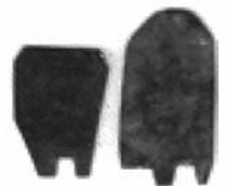
Zinken sjablonen om de hoekronden en de hoekige geren bij te werken in gips.
