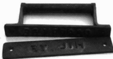
Metalen merkstempels voor gegolfde dakpannen
