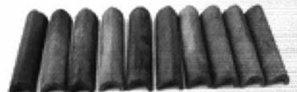
Bij een afbraakhandel te Poperinge vonden we 10 gelijkaardige kabeldeksels, binnendiameter 5 cm, lengte 33 cm.
