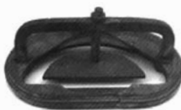
Binnenkant van de persvorm met de brug.
