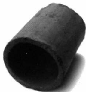
Moerbuis met binnendiameter van 20,4 cm, lengte 31,5 cm. Herkomst: boerderij Baljuwstraat te Reningelst. Productiecentrum onbekend. (GR)
