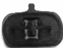
Binnenzijde van de persvorm met brug en tampons voor de holtes
