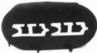
IJzeren persvorm voor twee smalle hoppeasttegels met twee perforaties. De metalen vorm is op een houten drager gemonteerd. De vers geperste stenen waren 11 cm breed en 5 cm hoog.
