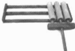
Het plaatsen van drie draneerbuisen met binnendiameter van 5 cm op een houten berrietje met de houten vork, "fourchette".
