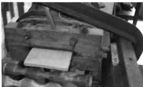
Detail van de persvorm voor haardtegels
