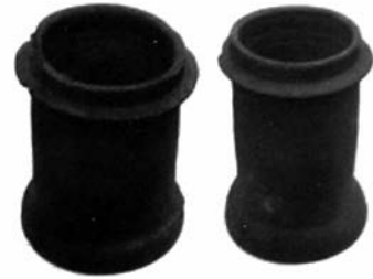
Twee handgedraaide rioolbuizen van rood ongeglazuurd aardewerk: - hoogte 35,8 cm, Ø bovenrand 24,5 cm, Ø onderrand 29 cm, uit de pottenbakkerij Dupont - hoogte 35,3 cm, Ø bovenrand 20,2 cm, Ø onderrand 25,5 cm, herkomst: Casselstraat 69 te Poperinge.
