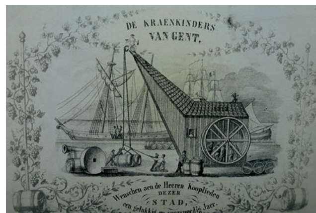
Figuur 1. Kraan door ‘kraankinders’ aangedreven in een tredwiel. De mannen aan de touwen op de kaai heffen niet, maar geleiden de tonnen in de goede richting (litho wenskaart, eerste helft negentiende eeuw (uit: Decavele en De Herdt, 1976).
