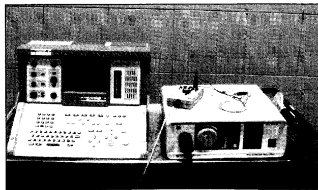
Figuur 1b. Het elektromyografietoestel (links) registreert de motorische antwoorden geëvoceerd door de magnetische stimulator (rechts).
