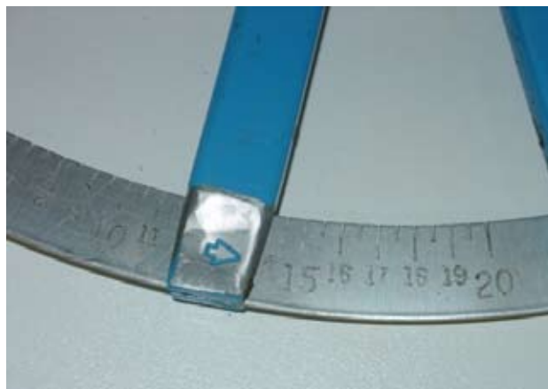
Figuur 2. Een gedetailleerde weergave van de schaalverdeling van de pelvimeter van Rice.
