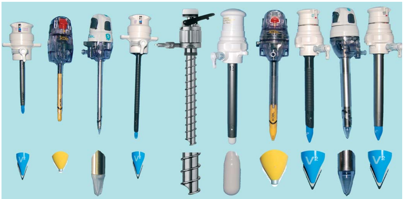
Figuur 3. Verschillende soorten trocars in hun bijhorende canule. De detailopname illustreert de verschillende variaties op de insteekpunt (blauw: metalen mes, geel: metalen mes met centraal stompe punt, metaal/transparant: kunststof scherpe punt, metaal: schroefdraad, wit: kunststof stompe punt).
