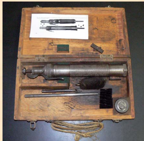
Slachtschiettoestel van iets modernere makelij aangedreven met patronen (Museumcollectie Diergeneeskundig Verleden, Merelbeke).
