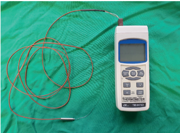
Figuur 6. Thermokoppelnaald met thermometer. Thermometer type TM-947SD van Lutron instruments, Taiwan. Met dit toestel kunnen vier temperaturen simultaan gemeten worden. De range van temperatuurmeting gaat van -100^{\circ}\text{C} tot 1300^{\circ}\text{C} .
