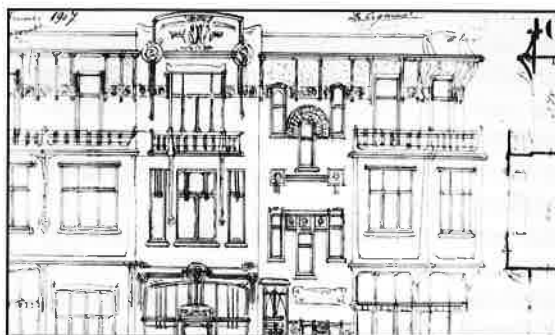
Bouwaanvraagtekening uit 1907 voor handelshuizen volledig opgetrokken in gewapend beton volgens het stelsel der gebroeders D'havé, Gent, in Art Nouveaustijl (foto verzameling auteur)
