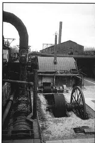
Aandrijfinstallatie van de (verdwenen) plaatwalserij (rechts) in de Nizhne-Tagilsky -museumfabriek, aangedreven door het stuwwater in de buisvormige overlaat (links).
