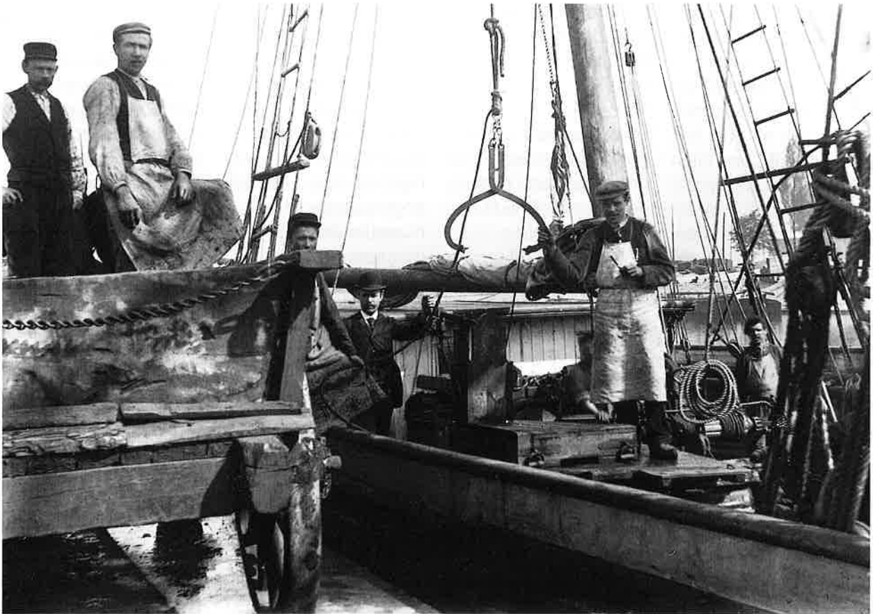
Het lossen van een ijschip. De ijsblokken werden via een hijssysteem met tang op de kar van de firma Donny geladen (vóór 1896).
