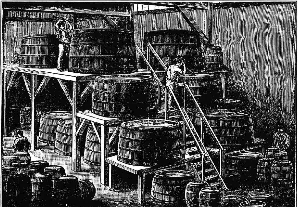
Productie van Schweinfurtergroen. Het bovenste vat bevat basisch arseniet en wordt gemengd met het koperzout in het er onder gelegen vat. Voor de reactie laat men het mengsel in een volgende vat lopen. De vloeistof wordt afgetapt en de neerslag is het groene pigment.
