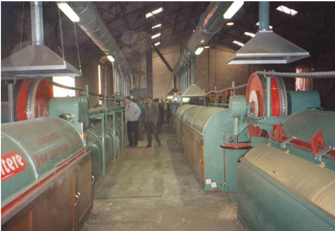
Na de crisis van de jaren zestig zetten de automatisering en mechanisering van de vlassector zich verder. Op deze foto is een volautomatische zwingelturbine te zien. Zwingellijn (© Algemeen Belgisch Vlasverbond)
