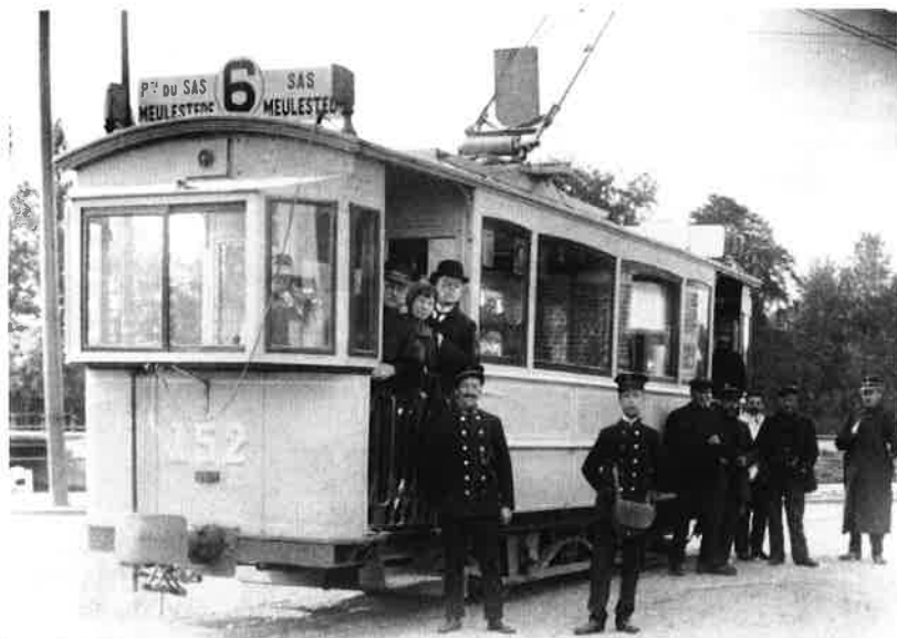
Aan de Muidebrug: de preekstoelentram kreeg een sleepbeugel als stroomafnemer (auteur onbekend, foto verzameling F. Coussens, Gent)
