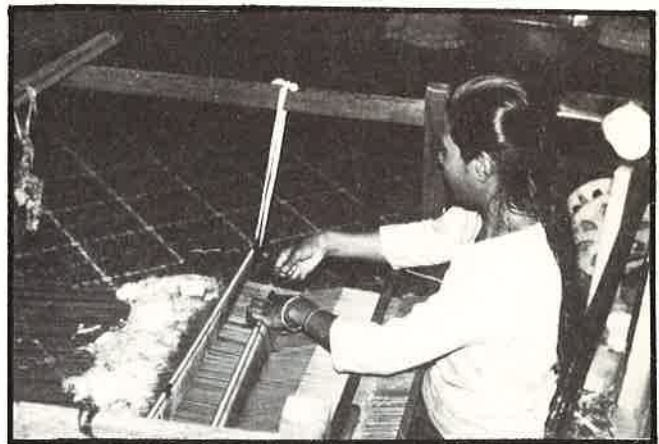
6. Het vervaardigen van de schachten voor de effenbinding. Eerste helft van schacht 2; einde.
