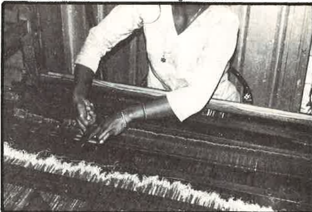
10. Het vervaardigen van de schachten voor de effenbinding. Tweede helft schacht 1; de binddraad wordt verder door de lussen van de eerste helft gestoken.
