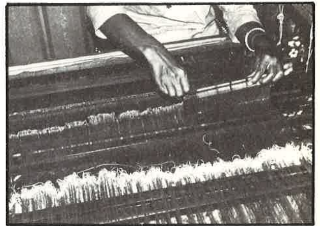
12. Het vervaardigen van de schachten voor de effenbinding. Tweede helft schacht 1 : het kaliber en de roeden worden enkele cm doorgeschoven.
