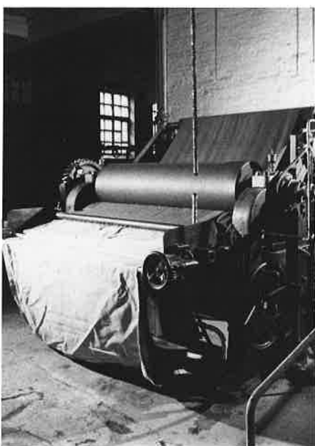
Wollakenwasmachine, regionaal fabriekaat 'Ateliers Raschon, ca. 1950) (links).
