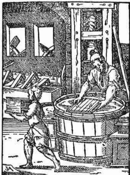
De papierfabrikant, naar een gravure van Josse Amman (XVIIde eeuw). Door de vensteropeningen ziet men de waterwielen die het stampwerktuig in beweging brengen, en rechts de schroefpers waarin het handgeschept papier geperst wordt om er het water uit te verwijderen. (uit: Papiertechniek, Instituut Gloireux, Oostakker 1941)
