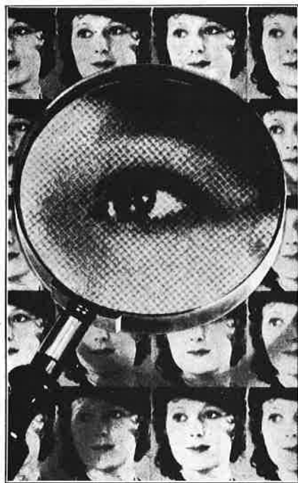
Het verschil tussen rotogravure-raster en autotypie-raster onder de loupe. Het eerste gaf veel fijnere druk dan het tweede. (fotos Nederlandse Rotogravure Mij, Leiden, z.d.)
