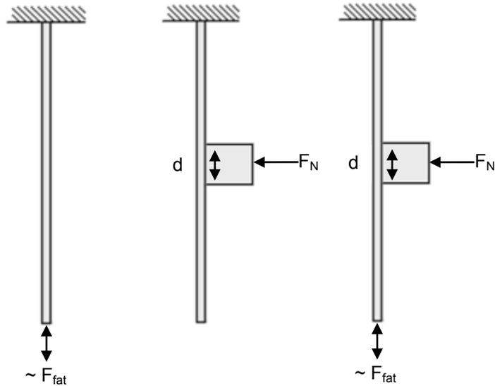
Figure 3: a) Fatigue b) Fretting c) Fretting fatigue
