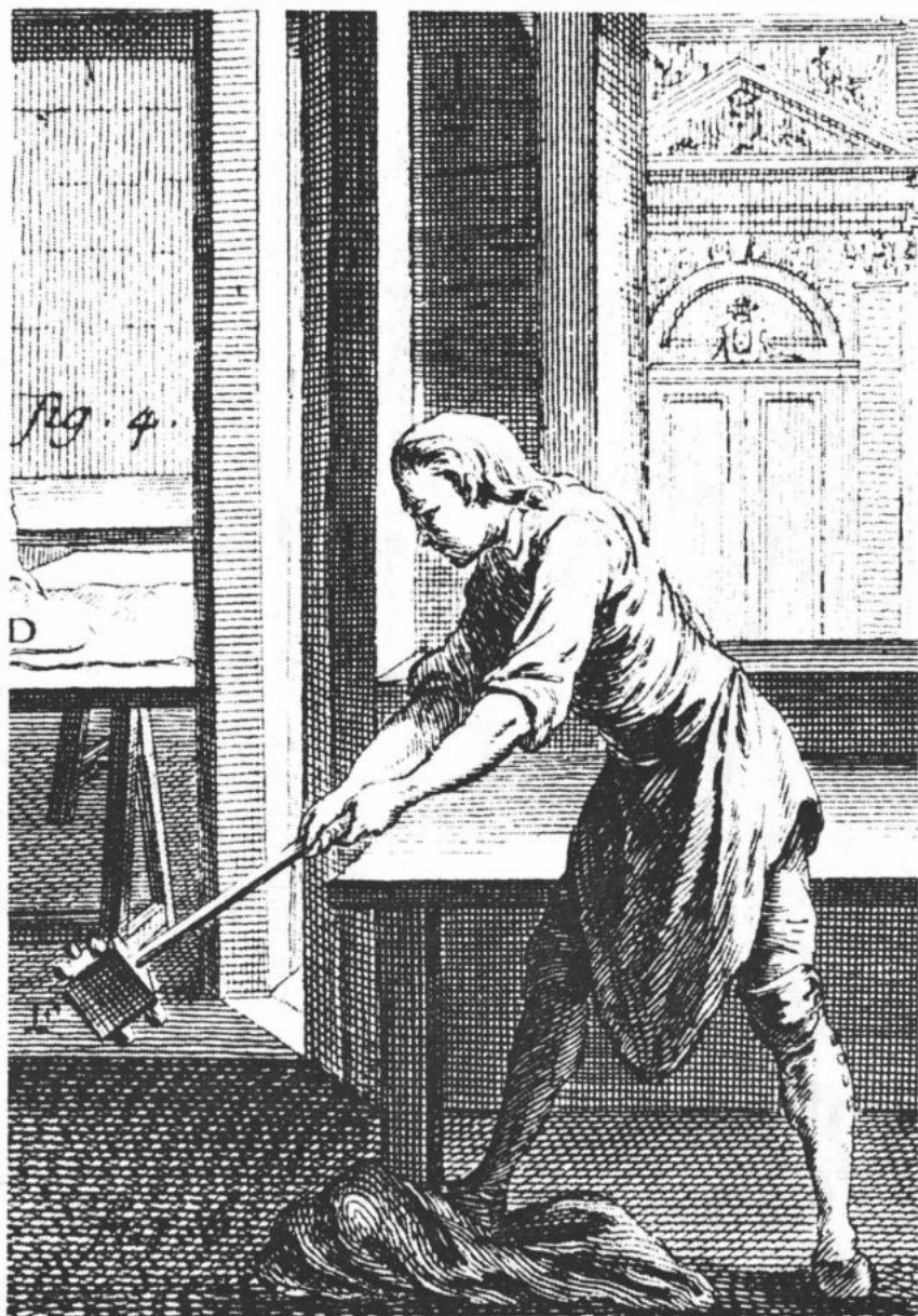
afb. 4 'het leder schuren over een geribte plank' uit: A. Diderot ..., o.c., plaat 394.
