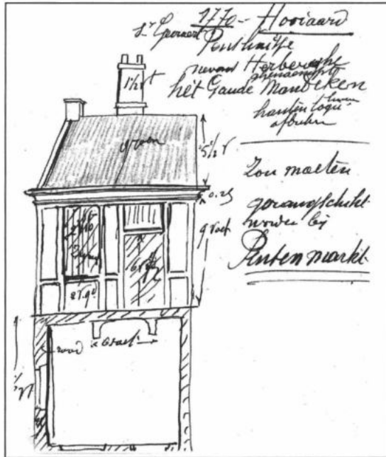
Afbeelding 2 Ontwerp voor het bijgebouwtje naast de Spijker, ingediend door Pieter de Maeght in oktober 1770. Op de bouwaanvraag staat de vermelding 'zwart' voor een vensteropening, terwijl 'groen' wijst op een leien dakbedekking (SAG., Oud Archief, Reeks 535, Huizen- Bouwaanvragen en veranderingswerken, nr. 103 (7), Hooiaard)
