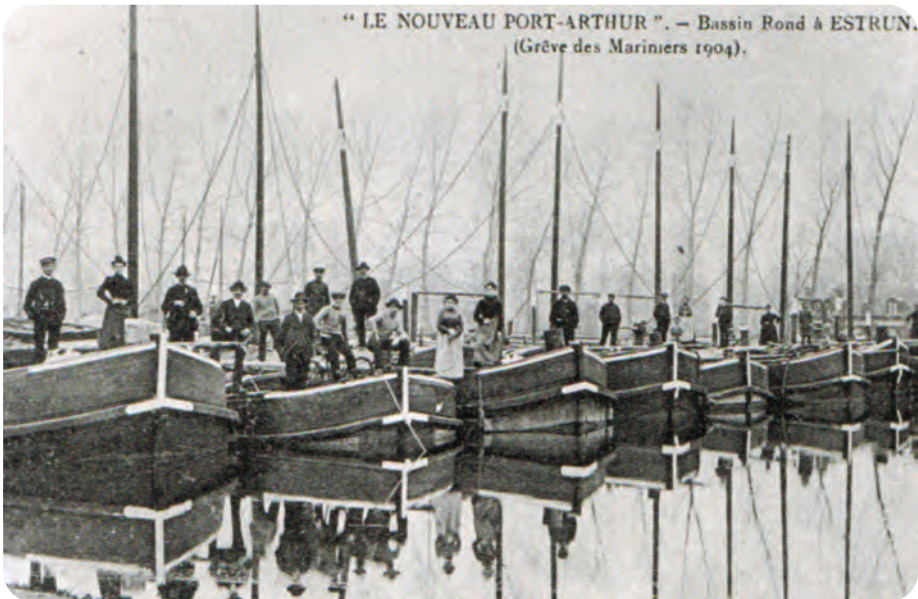
Afb. 3. Elk schip dat ingezet werd bij de hier getoonde blokkade van een Noord-Frans kanaal, was voorzien van een mast: geen zeil-, maar een 'trekmast' bij de motorloze binnenschepen. Het schepen trekken vanop de oevers gebeurde met een 'lijn' hoog aan die mast vastgelegd. Uit: Lekens, L., Lagrou, J. (2003). Archiefbeelden. Binnenschippers , Tempus, Stroud, U.K.
