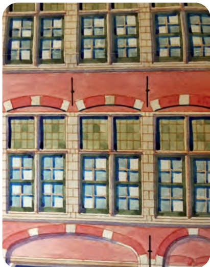
Afb. 7 links. Detail van de geveltekening van de gevel van Burgstraat 2 door arch. Amand Janssens (Archief Gent, reeks G). Men kan nu nog goed zien dat de vensters op de twee verdiepingen van elkaar gescheiden zijn door nauwe kolommen, opgebouwd uit witsteen blokken, zoals op de tekening weergegeven.
