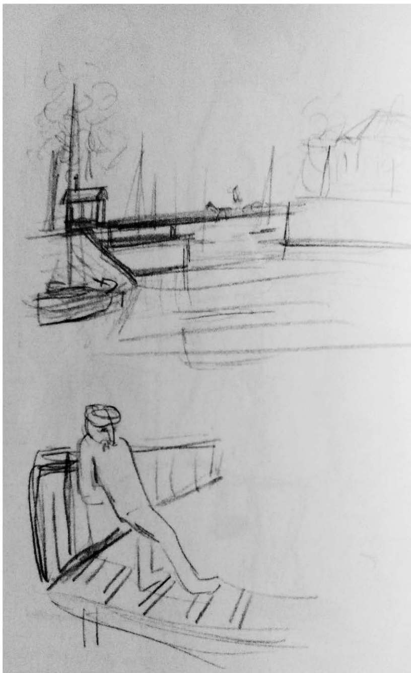
Afb. 4. Deze vlugge schetsjes van Francine Somers (overgenomen uit 'Ma chère ville de Gand') tonen hoe houten draaibruggen werkten. Boven links het vaste deel van de brug met het bruggenwachtershuisje op een korte dam. Rechts het draaiende deel.
