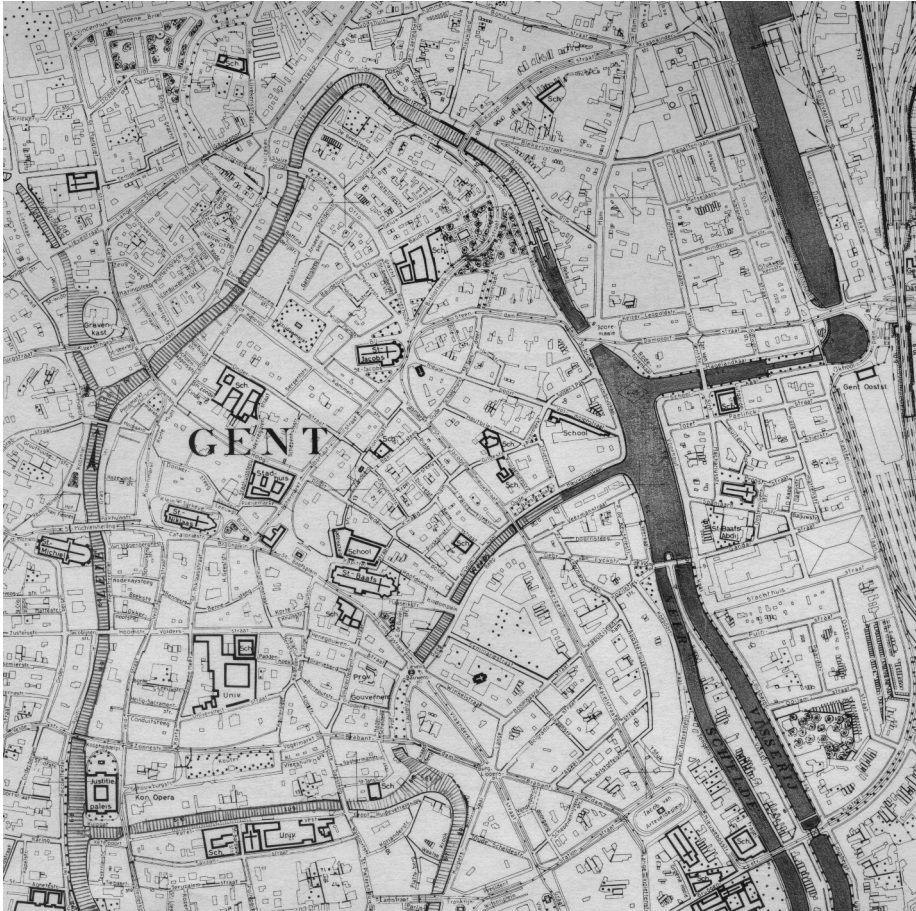
Afb. 2. Actuele situatie van het vaarcircuit met de twee waterpeilen (detail van de basiskaart 22.1.4 Gent, Ministerie van Openbare werken, 1960. Bewerking Herman Rosseau). Leie-Bovenschede (gearceerd) en Haven-Zeekanaalpeil (donker) in het centrum van elkaar gescheiden door de Sint-Jorissluis en de Scaldissluis.
