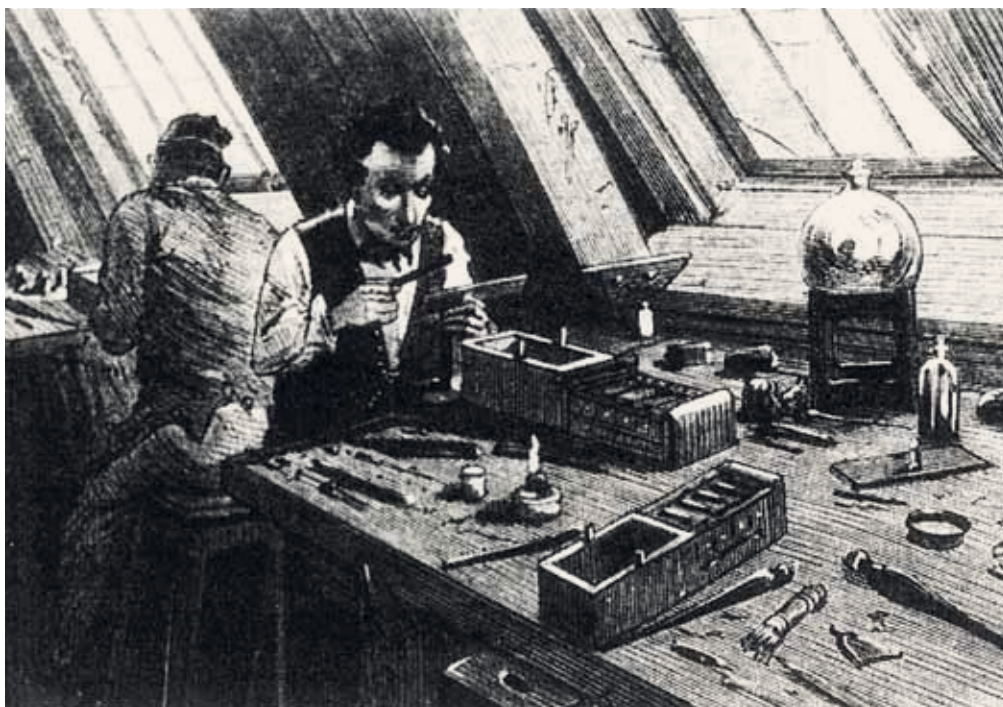
Een van de drie hoofdbewerkingen in de diamantnijverheid: het kloven ... (uit: Ad KNOTTER, Economische transformatie en stedelijke arbeidsmarkt. Amsterdam in de tweede helft van de negentiende eeuw )
