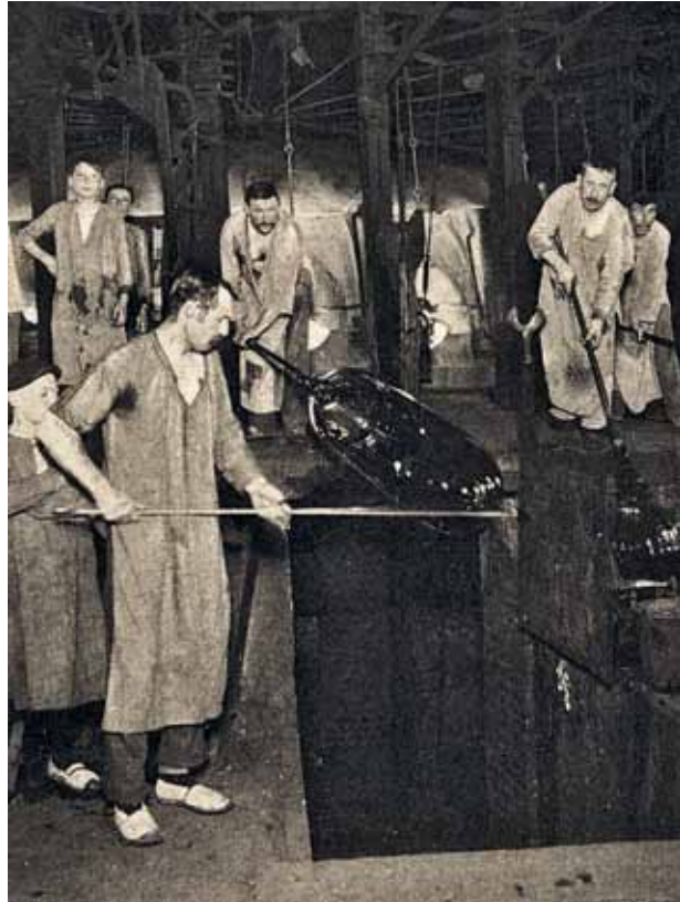
Na het blazen worden de cilinderkoppen afgesneden. (© Musée du Verre de Charleroi)
