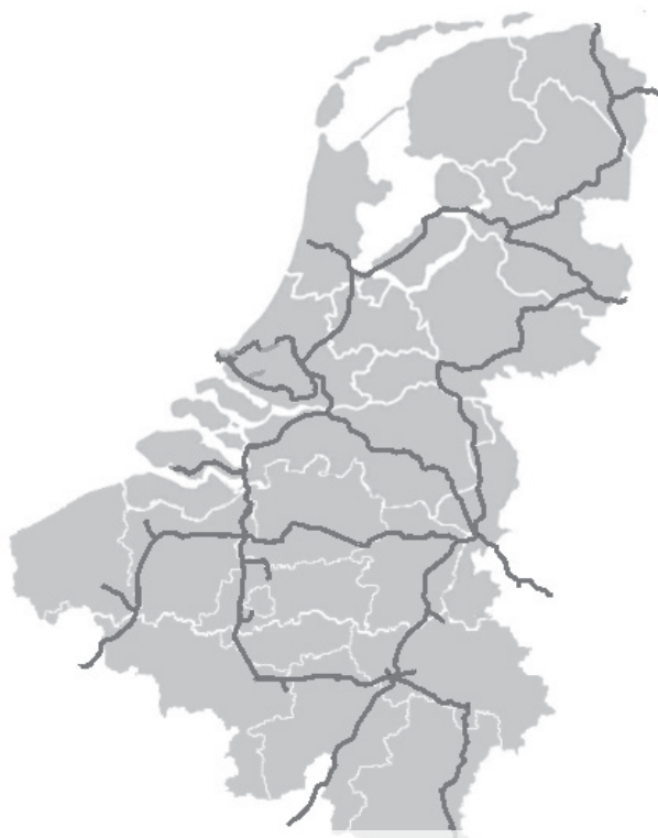
Hoogspanningslijnen van 380 kilovolt vormen de snelwegen van het hoogspanningsnet in Nederland en België Kaart: hoogspanningsnet.com
