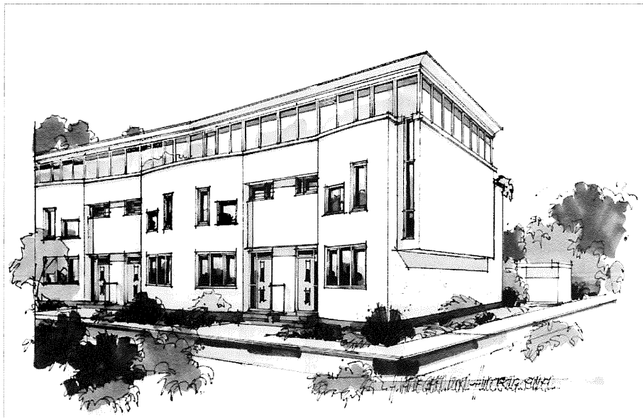
De begane-grondetage van het project van architect Pieter Weeda ligt ongeveer vijftig centimeter boven het maaiveld, zodat vanuit de woonkamer over de geparkeerde auto's heen gekeken kan worden. Bron: Bouwbedrijf Moes.
