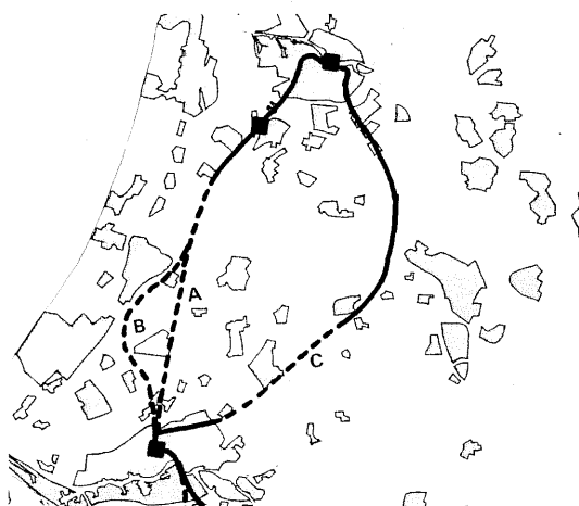
De tracé-varianten voor de HSL tussen Amsterdam en Rotterdam. De ononderbroken lijnen zijn bestaande lijnen; de gestreepte lijnen zijn nieuwe tracés:
